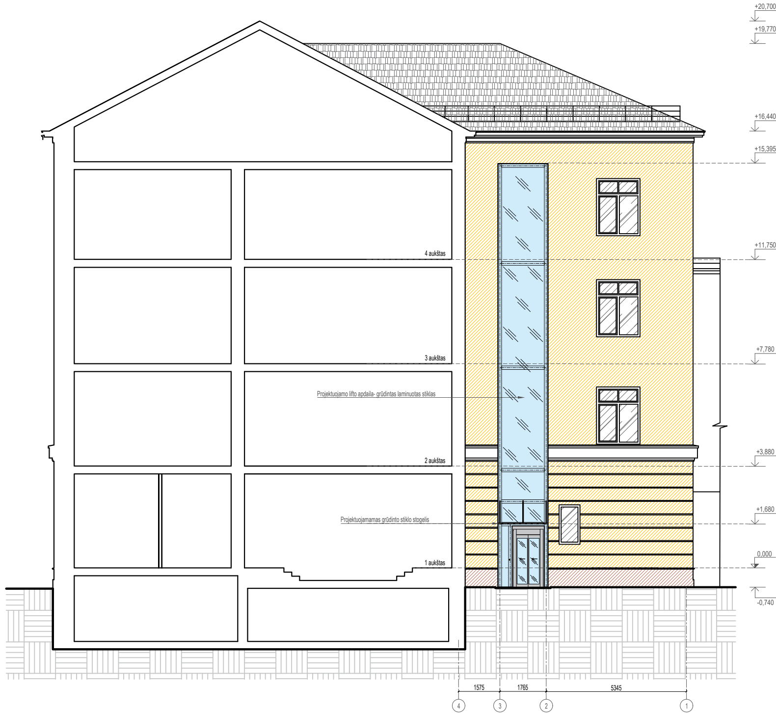
Projektuojamo lifto fasadas tarp ašių 2-3
