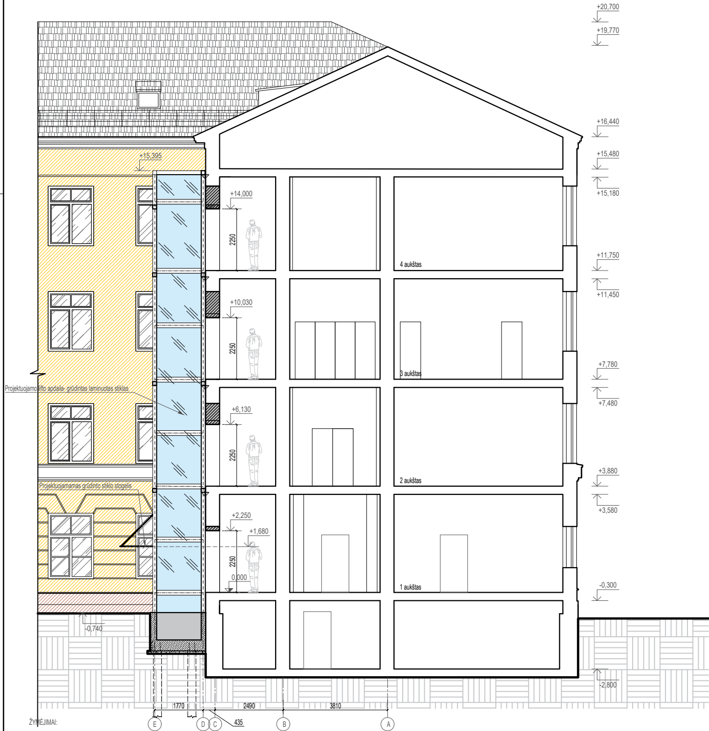
Projektuojamo lifto pjūvis fasade tarp ašių E-D
