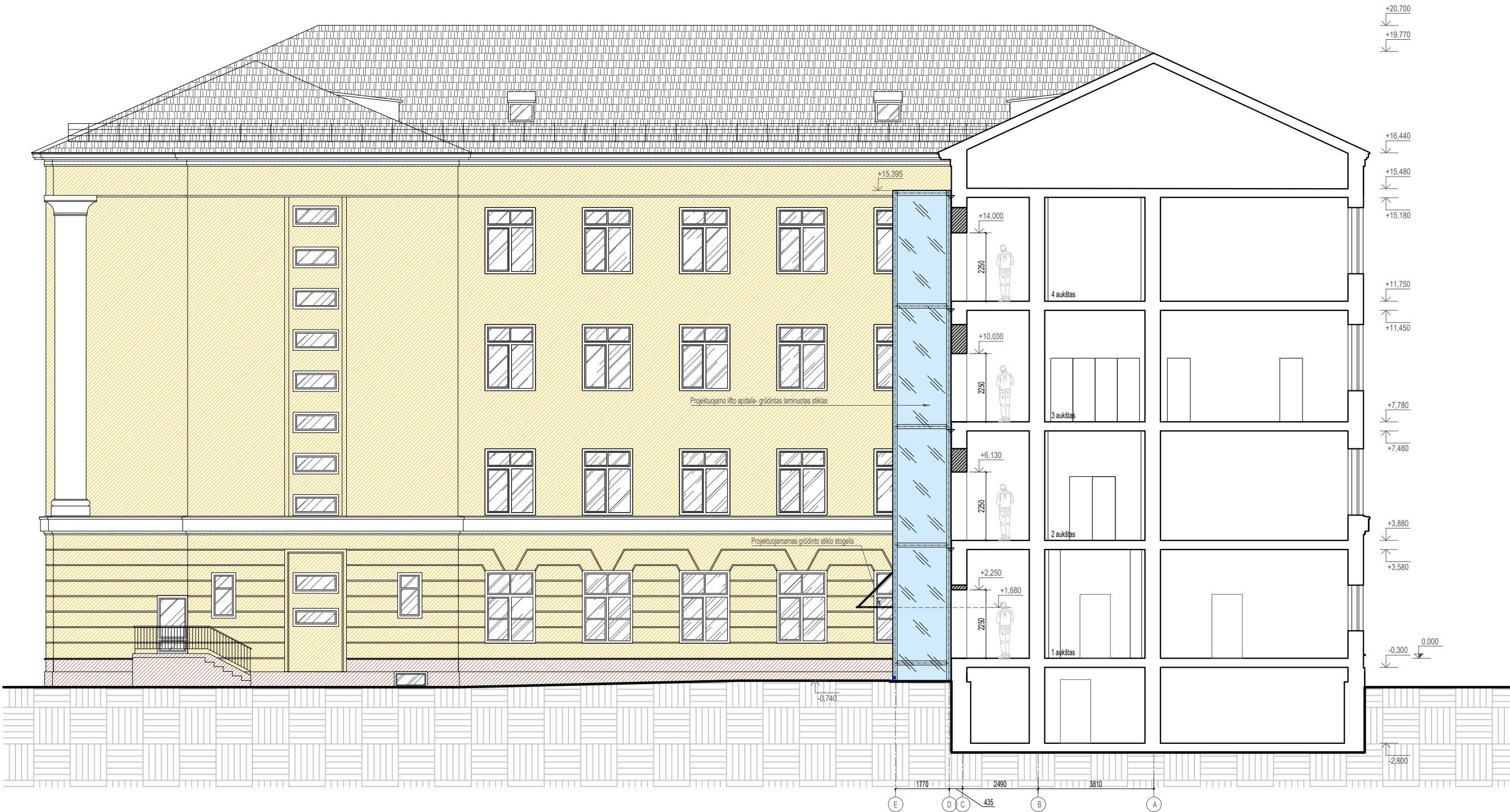
Projektuojamo lifto fasadas tarp ašių E-D
